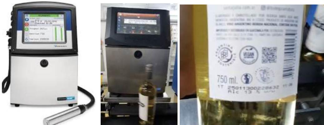
El inconveniente principal se centraba en la **acumulación excesiva de suciedad en el cañón de impresión** de la impresora VIDEO JET, afectando directamente la calidad de impresión y requiriendo frecuentes tareas de mantenimiento. El análisis determinó que dicha suciedad era consecuencia de **interferencias estáticas generadas por armónicos presentes en la red eléctrica**.
